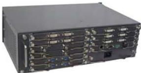
SPE 系列纯硬件拼接处理器，是一种多窗口管理的拼接控制器，使用 FPGA 阵列并行处理信号，系统主控芯片与系统计算芯片分离，采用主程序串行控制。该拼接控制器具有以下技术：
